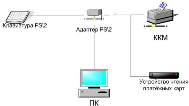
Наличие клавиатуры PS\2 и устройства чтения платёжных карт определяется составом поставки ККМ. Подробней про режим работы с адаптером PS\2 смотри приложение к «Руководству по эксплуатации» АТ006.00.00 РЭ.
